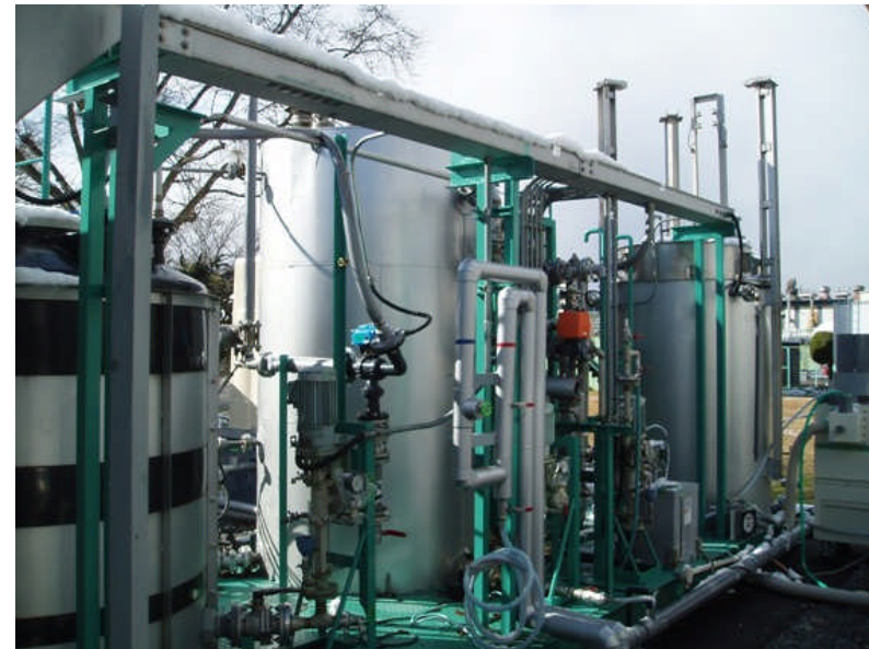
3m 3 -scale Methane Fermenter
